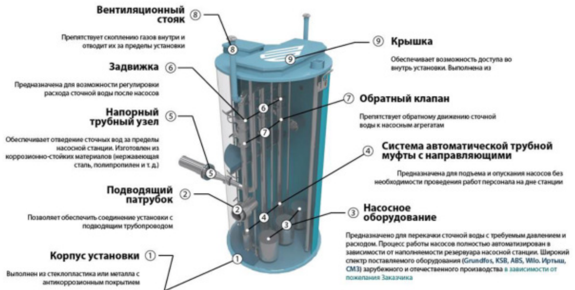
Рис. 6 Насосная станция
