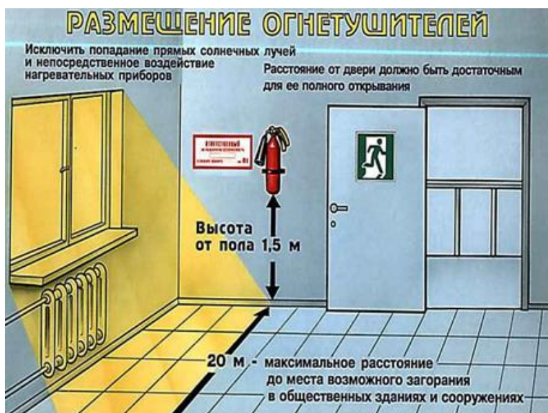
Рис. 9. Требования к размещению огнетушителей
