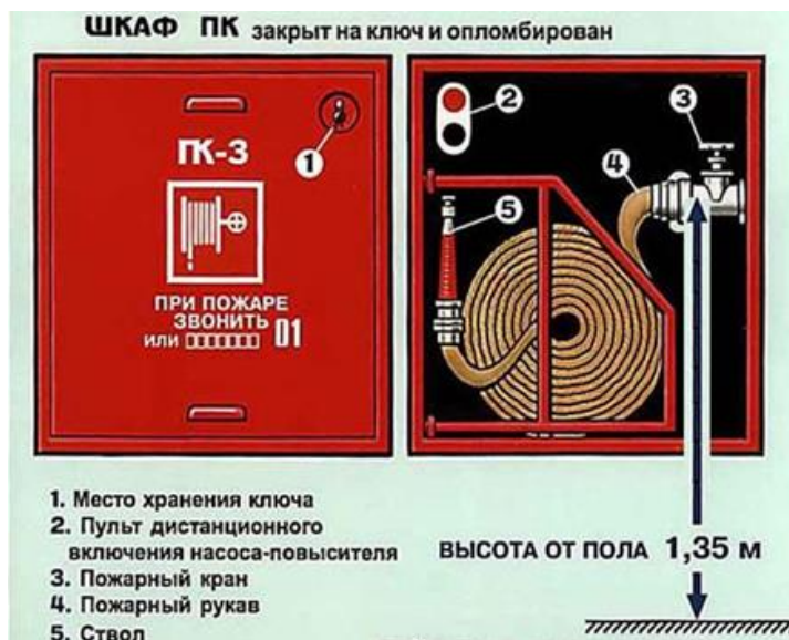
Рис. 13. Требования к размещению внутреннего пожарного крана
