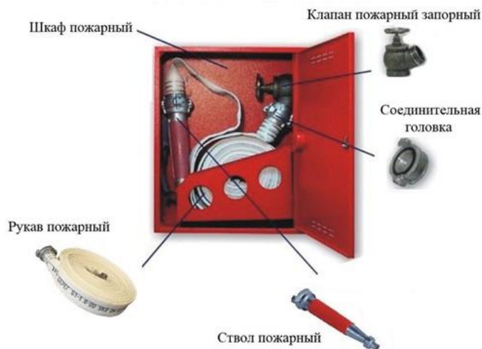
Рис. 13. Состав типового пожарного крана
