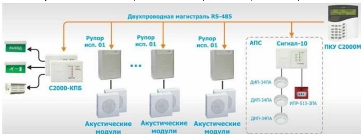
Рис. 6 Схема СОУЭ 3 типа с несколькими зонами оповещения
